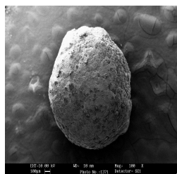
Figure 4. SEM photographs of MH gel beads using SA
